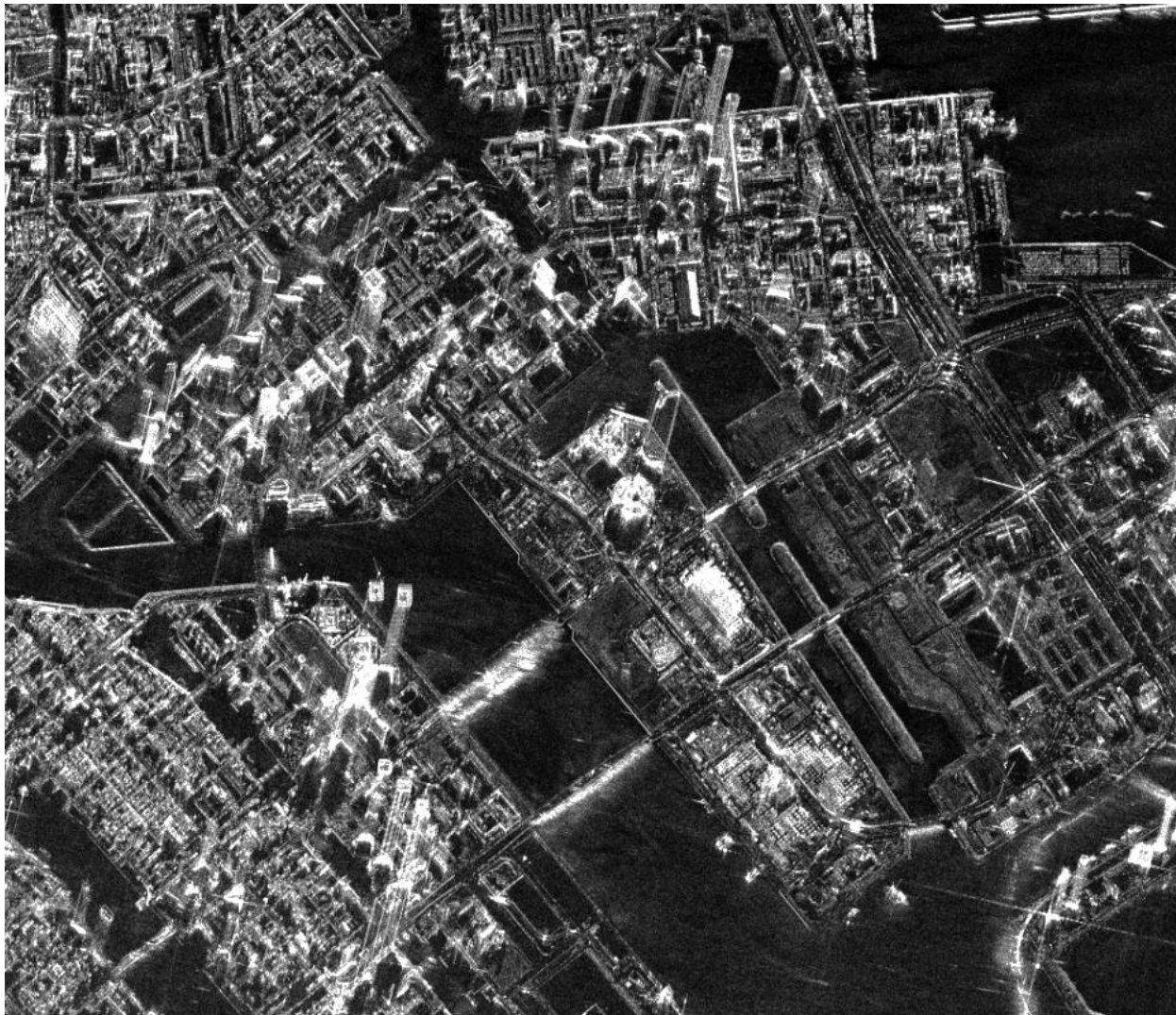
Рисунок 5.1 – Пример радиолокационного синтезированного изображения с КА «Кондор-Э» в режиме съёмки ДПР (разрешение 1-2 м), г. Токио, Япония
